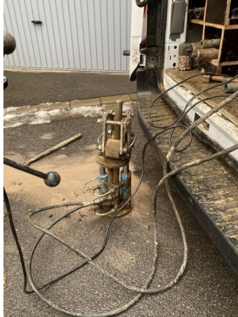
Hülse wieder aus dem Boden ziehen
